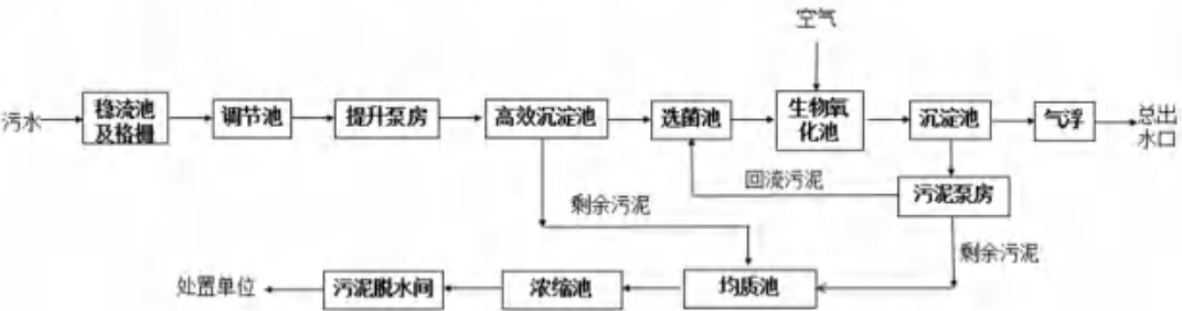
图4.2-2 二期工程40万吨/天工业污水处理工艺流程图
